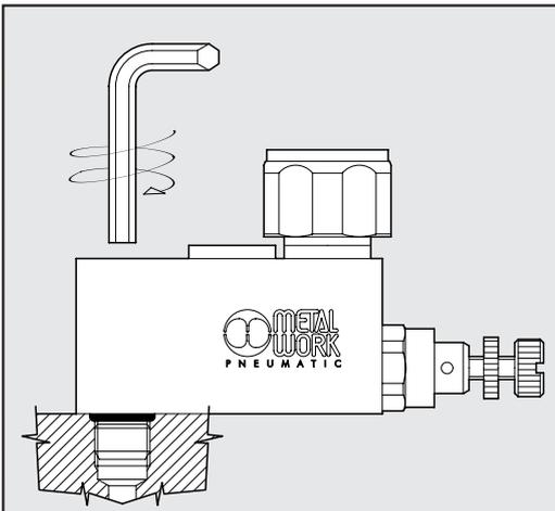
Befestigung des Druckminderers auf dem Ventil
