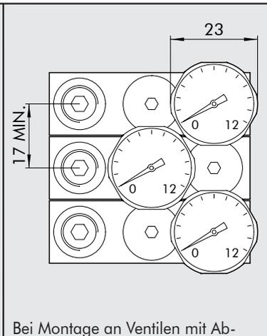
Bei Montage an Ventilen mit Abstand unter 23mm ist die Position von Manometern änderbar.
